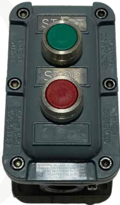
Botonera Marcha-Paro antideflagrante para uso en zonas con riesgo de explosión. Envoltorio Ex d equipado con un pulsador verde 2NO y un pulsador rojo 2NC, provisto de 2 entradas de cable 3/4" NPT.
